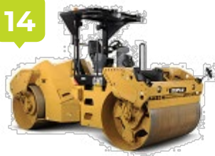
Compactadores de pavimento
