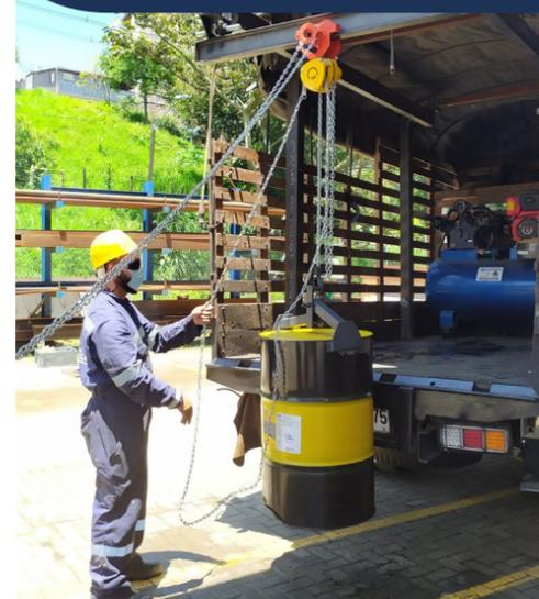
Instalación de puente grúa en vehículo para movimiento de bidones de combustible o aceite a través de un sistema de poleas.
